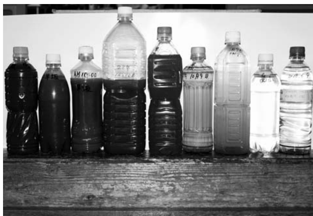
水道工事で生じた濁り水
